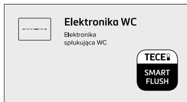
Po naciśnięciu przycisku szukaj urządzeń (**Search for devices**) aplikacja rozpocznie wyszukiwanie elektroniki TECEsolid. Rozpoznanie jest możliwe w zasięgu fotokomórki przycisku. Wybranie wskazanego urządzenia spowoduje nawiązanie połączenia. Uruchomienie w tym momencie przycisku zezwoli na przejście w tryb programowania.
