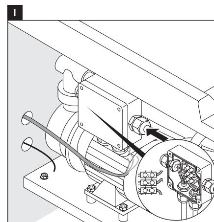
**II** Raccorder le câble pour la liaison équipotentielle à la baignoire balnéo.
