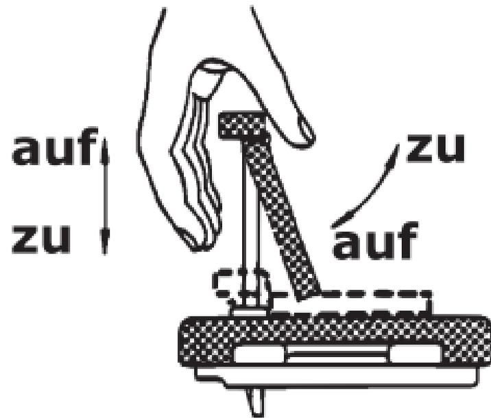
**ZUM VERSCHLIESSEN DES RÜCKSTAUVERSCHLUSSES
