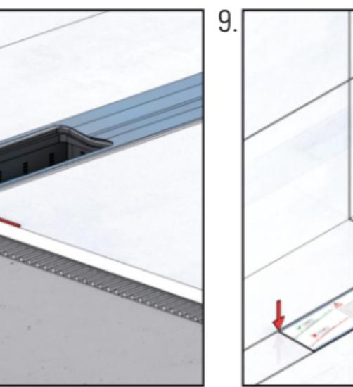
DE Fuge mit zementärem oder elastischem Fugenfüller schließen
