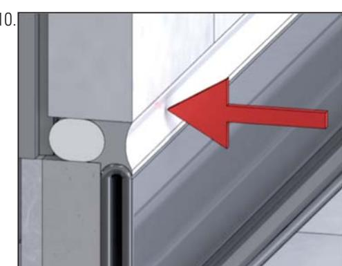
DE Fuge mit elastischem Fugenfüller schließen
