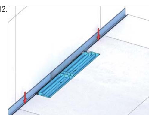
DE Fuge mit zementärem oder elastischem Fugenfüller schließen
